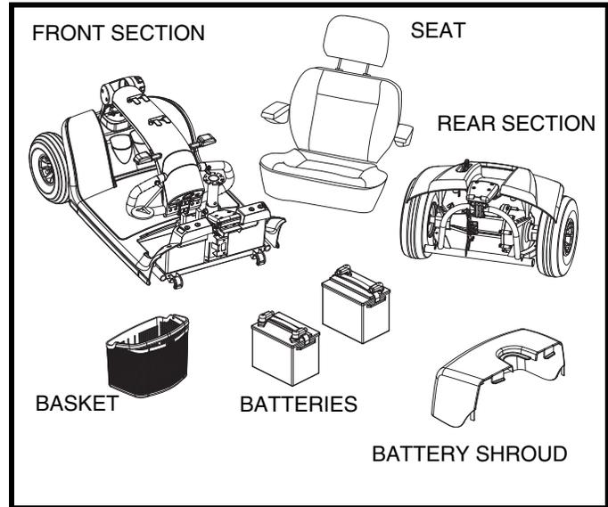
**Figure 18. Scooter Components**
